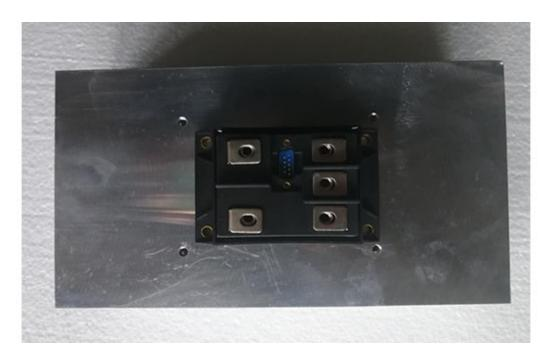
可控硅模块属于电气元器件,目前双向可控硅模块是比较理想的交流开关器件,它是从普通可控硅模块的基础上发展而来的,使用更加方便、安全可靠。下面正高来带您了解下双向可控硅模块的特点与性能。双向可控硅模块是由一对反并联连接的普通可控硅的集成,工作原理与普通单向可控硅相同。双向可控硅模块有两个主电极T1和T2和一个门极G□门极使器件在主电极的正反两个方向均可触发导通,所以双向可控硅在第1和第3象限有对称的伏安特性。双向可控硅模块门极加正、负触发脉冲都能使管子触发导通,因此有四种触发方式。双向可控硅应用为正常使用双向可控硅模块,需定量掌握其主要参数,对双向可控硅模块进行适当选用并采取相应措施以达到各参数的要求。特点:1对耐压级别的选择:通常把VDRM(断态重复峰值电压)和VRRM(反向重复峰值电压)中较小的值标作该器件的额定电压。2对电流的确定:由于双向可控硅模块通常用在交流电路中,因此不能用平均值而用有效值来表示它的额定电流值。由于可控硅的过载能力比一般电磁器件小,因而一般家电中选用可控硅模块的电流值为实际工作电流值的2~3倍。
